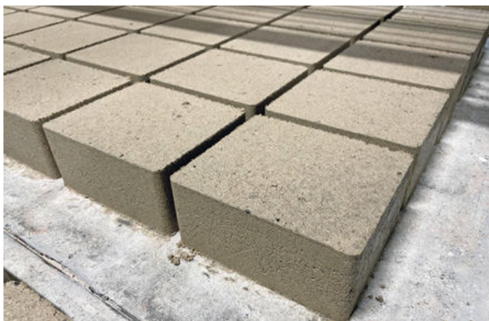
Zweischichtige Klimabetonpflastersteine, hergestellt mit Geoprime®-Technologie (Kernschicht).
