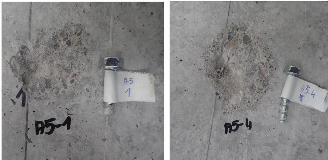
Bild 4-12: Darstellung des Versagens unter Querbelastung mit geringer Verankerungstiefe ( $h_{nom} = 20$  mm) in Hohldeckenplatten.
