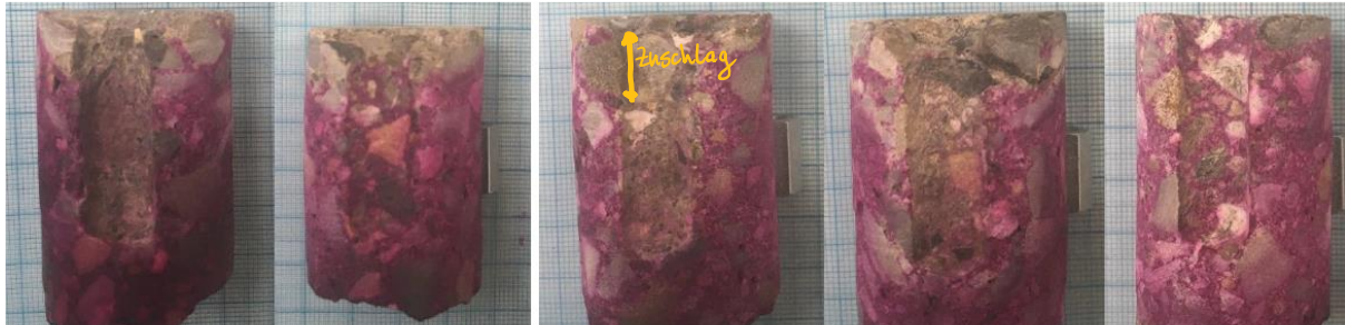
Bild 4-6: Exemplarische Darstellung der Karbonatisierungstiefe nach einer Auslagerungszeit von 72 Tagen bei 3 % CO 2 Gehalt.
